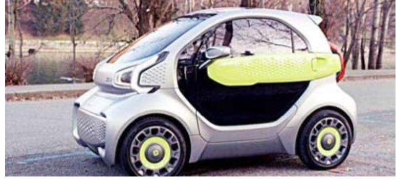
كيلومتر في الساعة. وتتمتع السيارة الكهربائية الصغيرة بمدى سير يبلغ 150 كيلومتر بفضل بطارية ليثيوم فوسفات الحديد سعة 2.9 كيلوواط ساعة.
